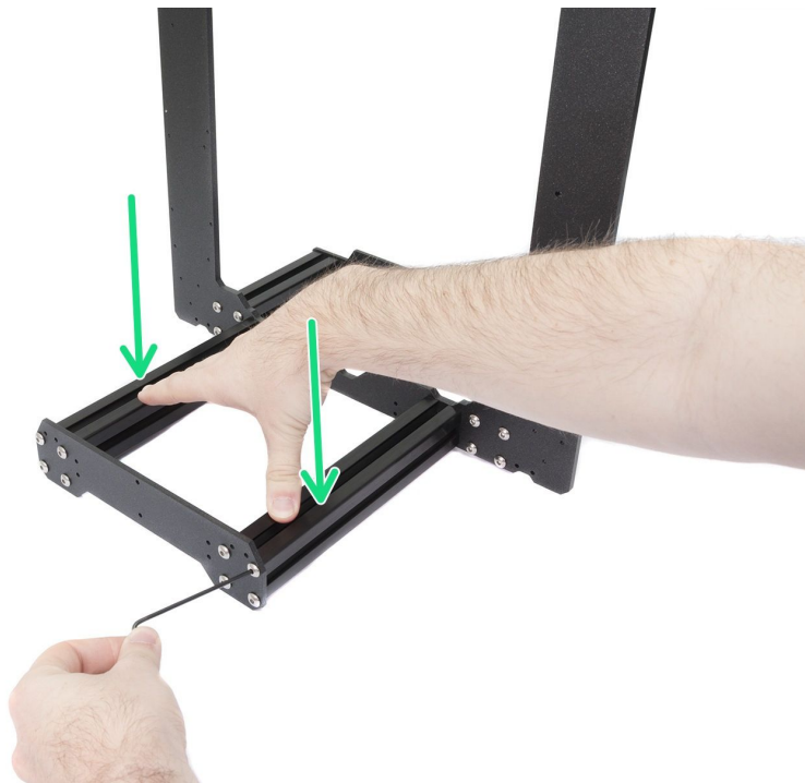
Immagine 46 - il modo corretto di stringere il telaio, le piastre e i profilati d'alluminio.
