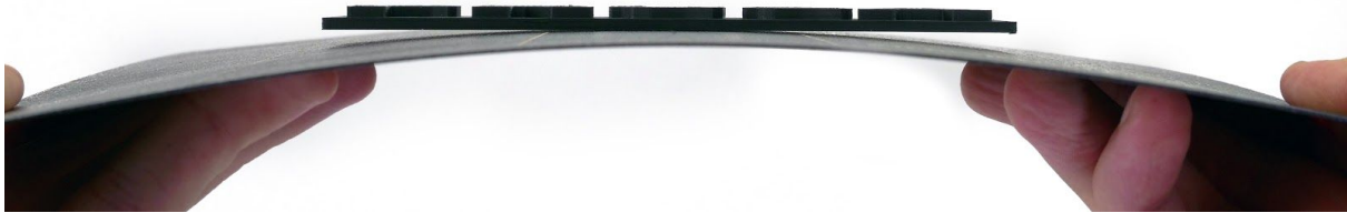
Image 14 - Retrait du modèle de la surface d'impression en PEI en courbant la feuille en acier
