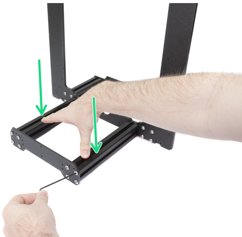
Image 46 - Comment serrer correctement ensemble le cadre, les platines et les extrusions.
