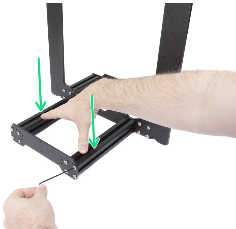
Obr. 46 - Správný způsob utažení rámu, desek a hliníkových extruzí dohromady
