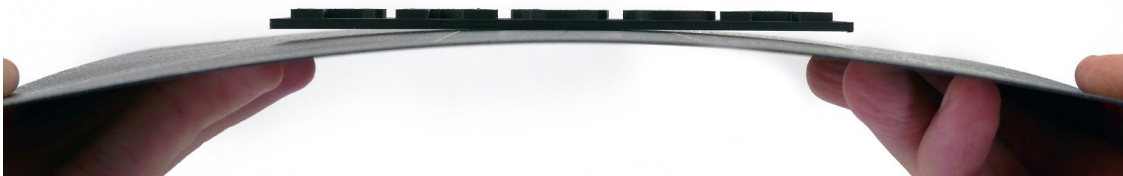
Obr. 14 - Sundání modelu z PEI povrchu prohnutím ocelového plátu. Pokud výtisk z podložky přesto nejde sundat, zkuste plát ohnout dovnitř.
